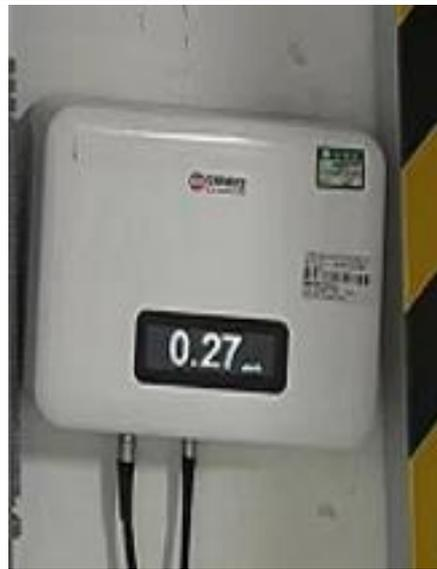
图 4-9 在线 $\gamma$ 辐射监测仪
