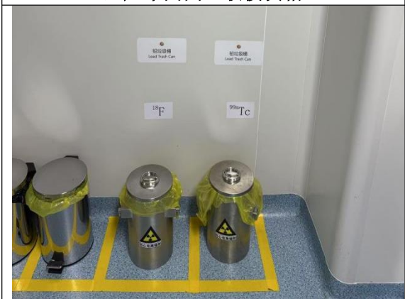
放化实验室放射性废物收集桶
