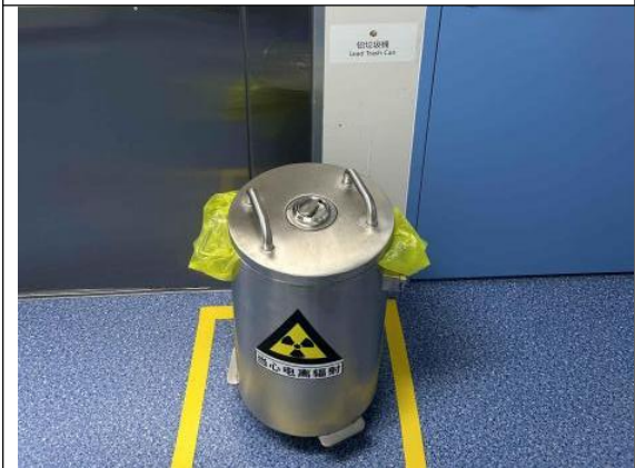
生产车间二放射性废物收集桶
